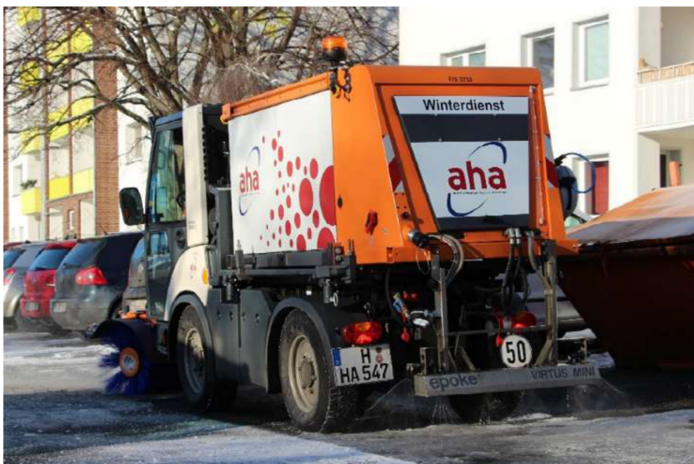
Optimale Streustrategie: Aufspritzen von Salzlösung nach Kehren des Schnees
